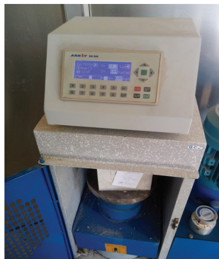
شکل ۹: اندازه‌گیری مقاومت فشاری نمونه مکعبی پرکننده بتنی
