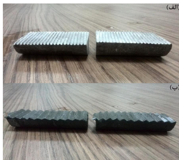
شکل ۱۵: مقایسه الگوی زبر کنگره‌ای (دندانه اره‌ای) اجرا شده بر روی دو نمونه الف) طبیعی و ب) مصنوعی، الف) نمونه طبیعی برش خورده با استفاده از دستگاه برش CNC، ب) نمونه بتنی قالب‌گیری شده با طراحی و ساخت الگوی ابتکاری طراحی شده
