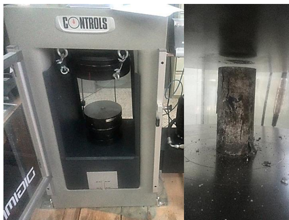
شکل ۱۳: آزمون مقاومت فشاری تک‌محوری مغزه‌های مصنوعی
