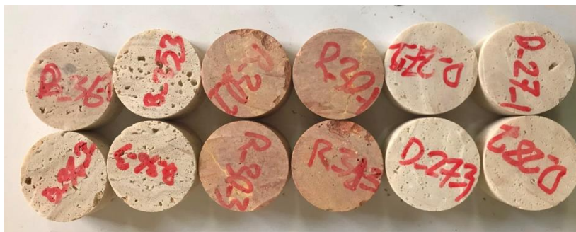
شکل ۷: تعدادی از نمونه‌های آماده شده برای آزمایش برزیلی
