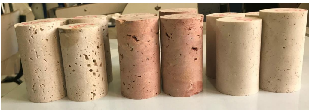
شکل ۸: تعدادی از نمونه‌های آماده شده برای آزمایش تراکم تک محوری
