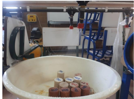
شکل ۵: تجهیزات مورد استفاده برای شبیه‌سازی باران اسیدی
