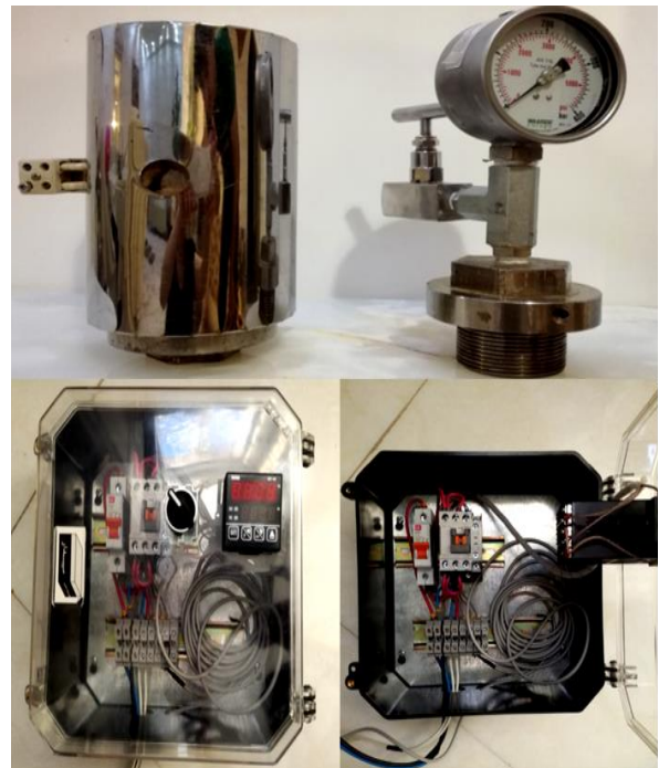
شکل ۴: تصویری از دستگاه پیرولیز آبی شامل بدنه و درب دستگاه به همراه جعبه کنترل و گرمایش دستگاه
