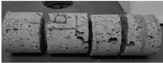
شکل ۱۴: نمایی از شکست ایجاد شده در اثر ۳ مرحله CST روی یک نمونه مغزه
