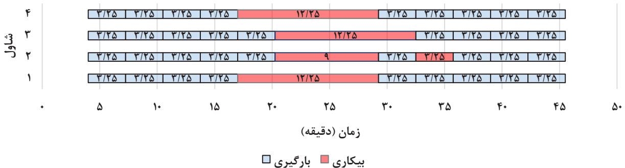
شکل ۴: زمانبندی بارگیری کامیون‌ها و زمان بیکاری شاول‌ها (نتایج TSSA)
