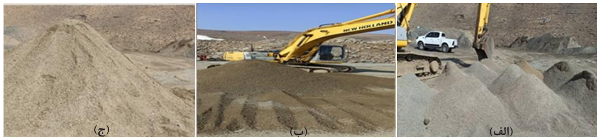
شکل ۲: مراحل نمونه‌برداری از دپوهای باطله کارخانه فرآوری سنگ آهن دانه‌بندی بالستان
